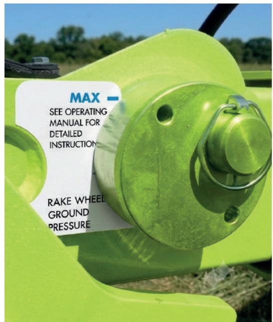
Leva para la fácil regulación de la presión de las ruedas (o estrellas) contra el suelo.
